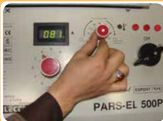
کلید انتخاب جریان مناسب بر حسب نوع الکتروود جوشکاری
