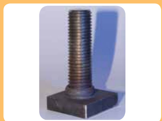
نمونه قطعه جوشکاری شده به روش اصطکاکی
