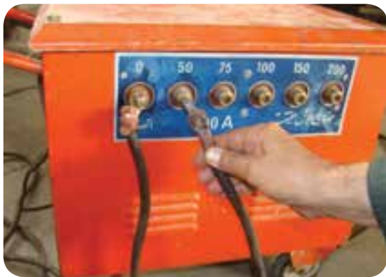
تنظیم آمپر در دستگاه ترانسفورماتور پله‌ای
