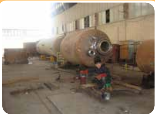
ب) کارگاه ساخت مخازن تحت فشار
