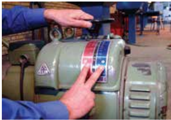
سیستم اهرمی جهت تغییر آمپر دستگاه دینام جوشکاری
